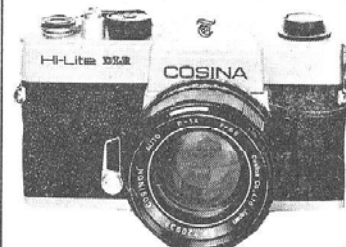
Cosina Hi Lite Systemkamera med udskiftelig optik i Pentaxgevind. Spaltelukker 1-1/1000 sek + B. Selvudløser. TTL belysningsmåler.
